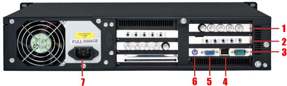
1. Video-In×4(選購) 2. Line In × 4(選購) 3. COM Port 4. 乙太網路 5. VGA 6. PS/2 7. 電源接頭
